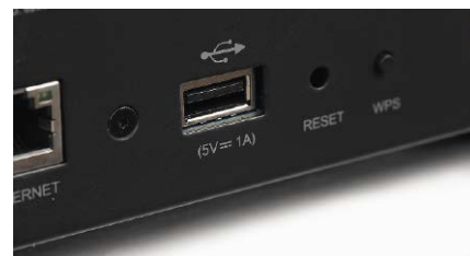
Jedno z dodatkowych gniazd USB służy do podłączenia nośników pamięci.
